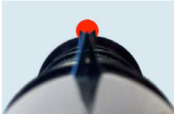
Figur 2: De tre taggene slik de skal se ut når man har siktet riktig på objektet (her illustrert med en rød skive).
